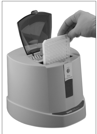
Figure 2: Chargement d'une plaque PCR
