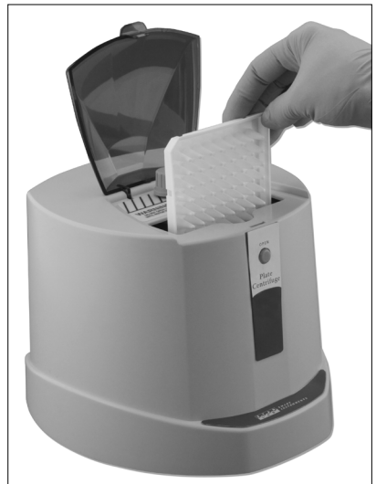
Abb 2: Beladung einer PCR-Platte
