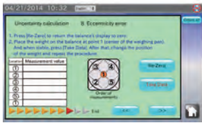
Eccentricity error test
